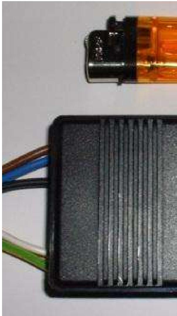
Die Schaltung für die Abschaltverzögerung und die Spannungsversorgung der Kamera über ein Minirelais kann dann z. B. so aussehen. Das Feuerzeug zeigt im Vergleich die Größe des Gehäuses.
